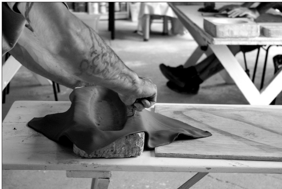
Figura 35: L'impasto di creta viene adeguato allo stampo, ogni ceramica è un “pezzo unico” lavorato artigianalmente.
